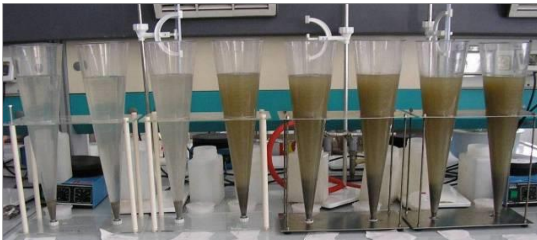
Figura 4-3: Batteria di coni Imhoff.
