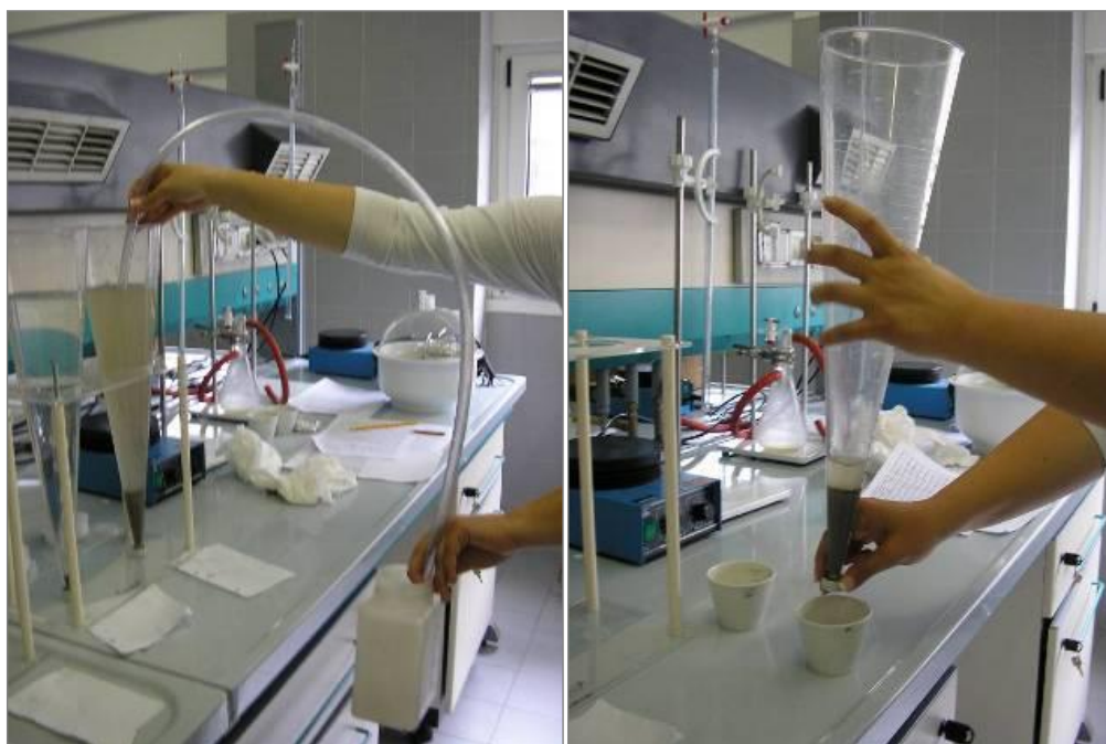
Figura 4-4: Recupero del surnatante (a sinistra) e della frazione sedimentata (a destra).
